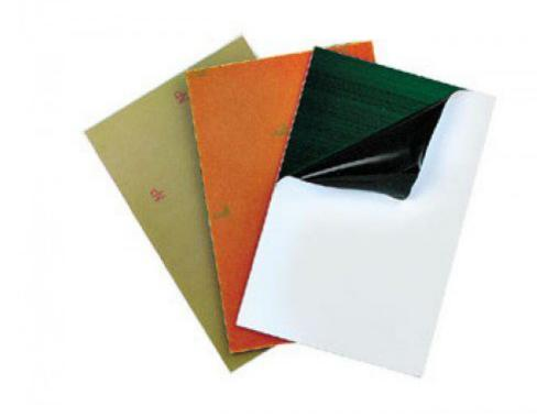
Piastra in vetronite spessore 1,6 mm ricoperta da uno strato uniforme di rame da 35 micron e fotoresist. Singola faccia, dimensioni 160 x 233 mm.
