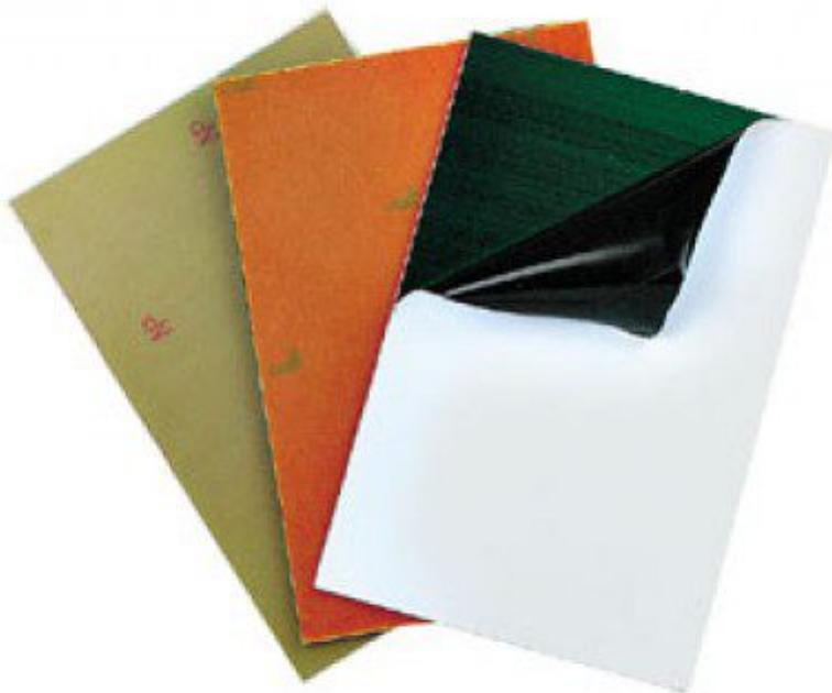
Piastra in vetronite dello spessore di 1,6 mm ricoperte da uno strato uniforme di rame da 35 micron e fotoresist. Singola faccia. Dimensioni 200 x 300 mm.
