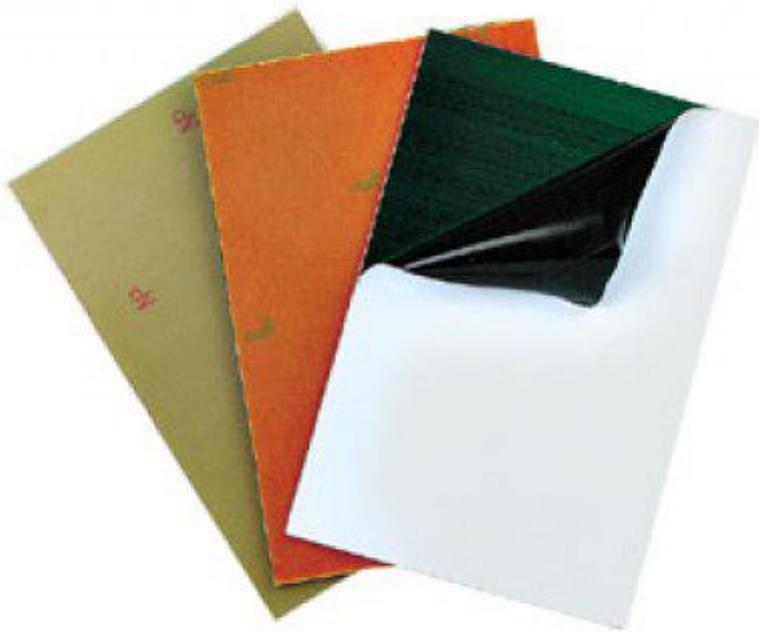
Piastra in vetronite dello spessore di 1,6 mm ricoperte da uno strato uniforme di rame da 35 micron e fotoresist. Doppia faccia. Dimensioni 200 x 300 mm.
