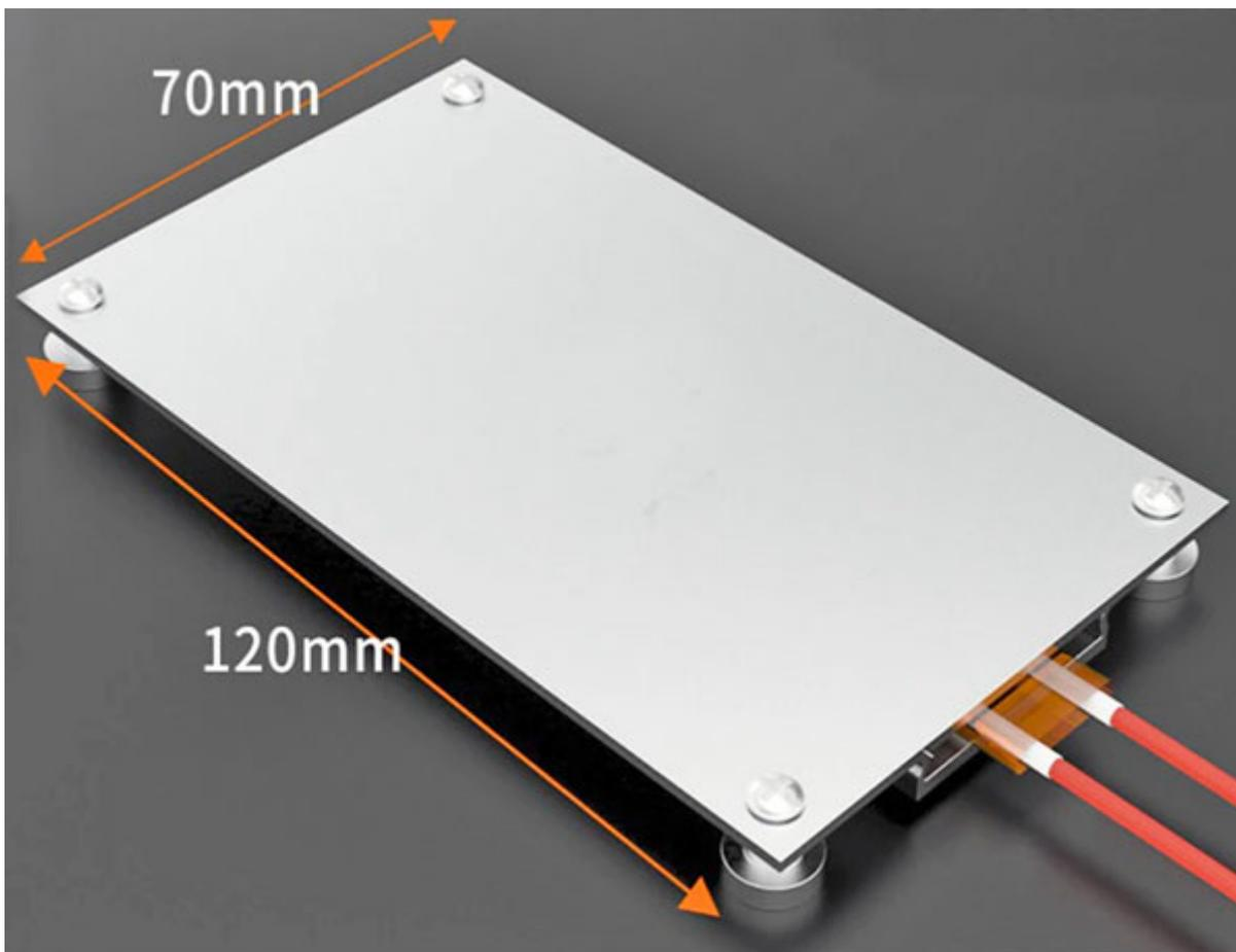
Piastra riscaldante da 400 watt con alimentazione 230 VAC. Una volta alimentata, raggiunge una temperatura di 260°C ( $\pm 10^\circ$ ) in circa 30 secondi. Il corpo esterno è realizzato in alluminio. La confezione comprende: la piastra riscaldata, 4 piedini con relative viti, una pinzetta e un connettore per effettuare il cablaggio elettrico..
