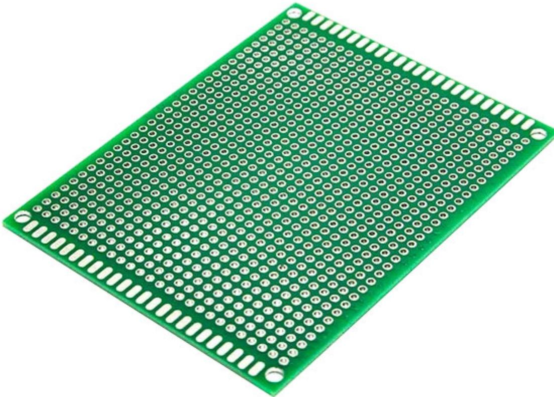
Piastra millefori doppia faccia con fori metallizzati, righe e colonne contrassegnate con lettere e numeri. Materiale: FR4 (Flame Resistant n.4), spessore del rame: 1-4 OZ, diametro del foro: circa 1 mm, dimensioni piastra (mm): 120x80x1,6.
