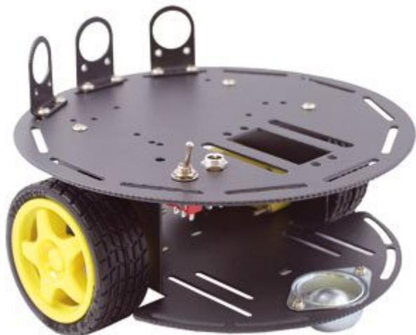
Piattaforma robotica costituita da un corpo in alluminio, due motoriduttori, due ruote Tamiya racing (diametro 65 mm), un ballcaster in metallo, un deviatore, un presa di alimentazione, le viti e i dadi. Utilizzata con le schede Arduino o Seeeduino permette di realizzare in modo semplice e veloce dei robot completi.
