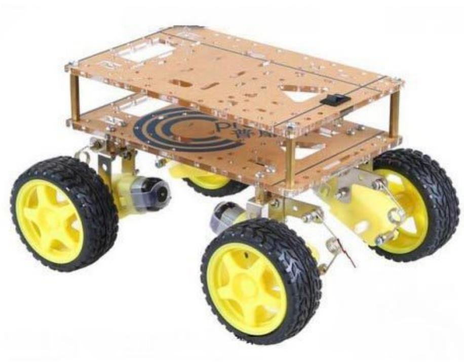
Piattaforma robotica costituita da un corpo in materiale acrilico, quattro motoriduttori, quattro ruote da 65 mm di diametro con pneumatico in gomma morbida con larghezza 26 mm, quattro sospensioni a molla. La confezione comprende anche un portabatteria, un mini interruttore e fili di collegamento per i motoriduttori. Può essere utilizzata in abbinamento ad Arduino (o compatibili), sensori, ecc.
