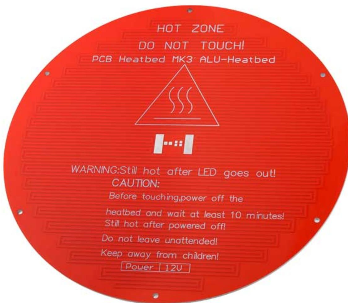
Realizzato in alluminio con spessore da 3 mm questo piatto riscaldato è in grado di raggiungere una temperatura superiore ai 100°C. Si alimenta con una tensione continua di 12 volt (10 A) e tramite l'apposita scheda che gestisce la stampante può essere regolata la temperatura. Temperatura di lavoro: da -40°C a +125°C, dimensioni (mm): 220x3, peso: 306 grammi. Il piatto riscaldato in alluminio viene fornito completo di distanziali in nylon, clip di fissaggio per piatto in
