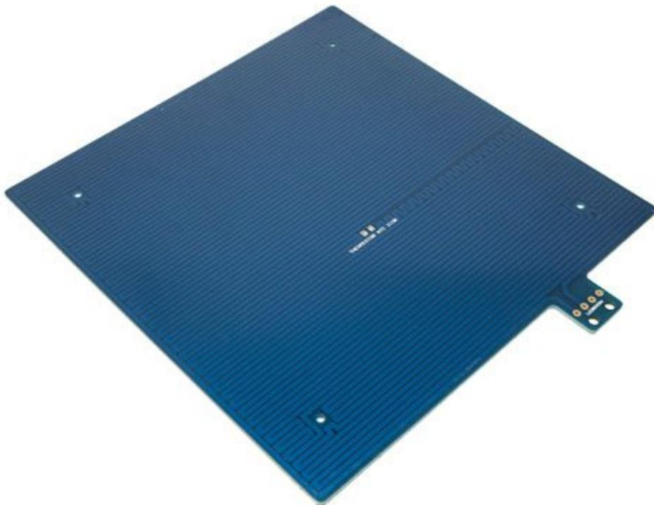
Piatto riscaldato per stampante 3D in grado di raggiungere una temperatura di 60°C. Si alimenta con una tensione di 15 V e assorbe circa 3 A. Dimensioni (cm): 21x21, dimensioni area di stampa (cm): 19 x 18,7. Per un corretto funzionamento è necessario collegare una NTC da 100 kohm SMD.
