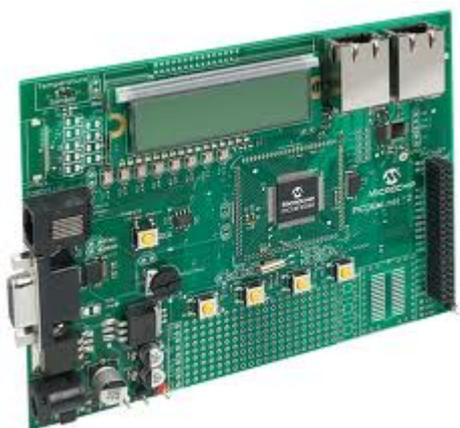
Il prodotto PICDEM.net 2 è una scheda di sviluppo Internet/Ethernet, supporta sia il controller Ethernet ENC28J60 sia il microcontrollore Ethernet PIC18F97J60. Con questa scheda, scaricando gratuitamente dal sito microchip lo stack TCP/IP, è possibile sviluppare un web server attraverso il quale è possibile monitorare e controllare applicazioni stand-alone attraverso internet.
