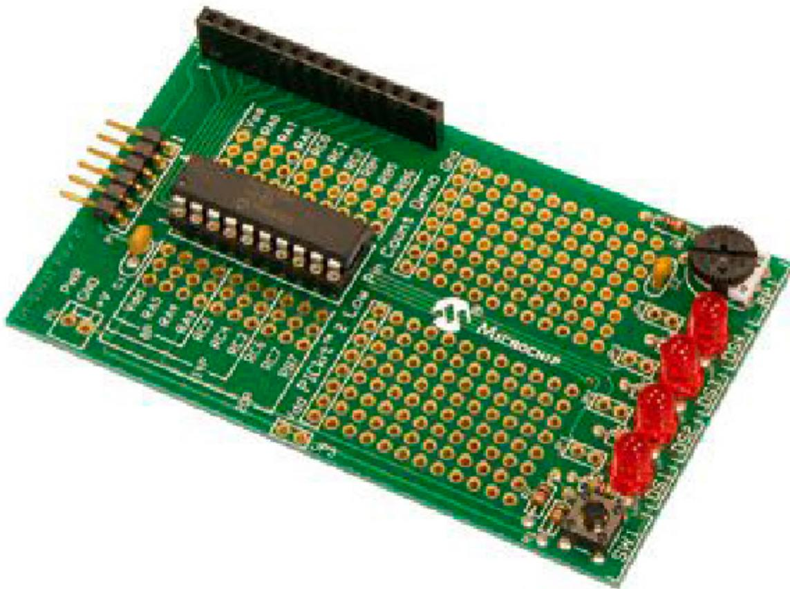
Piccola demo board dotata di un PIC16F690 e una sezione sperimentale per realizzare piccole connessioni. Da utilizzare in abbinamento al programmatore PICkit 2. La confezione comprende una demo board montata e due circuiti stampati.
