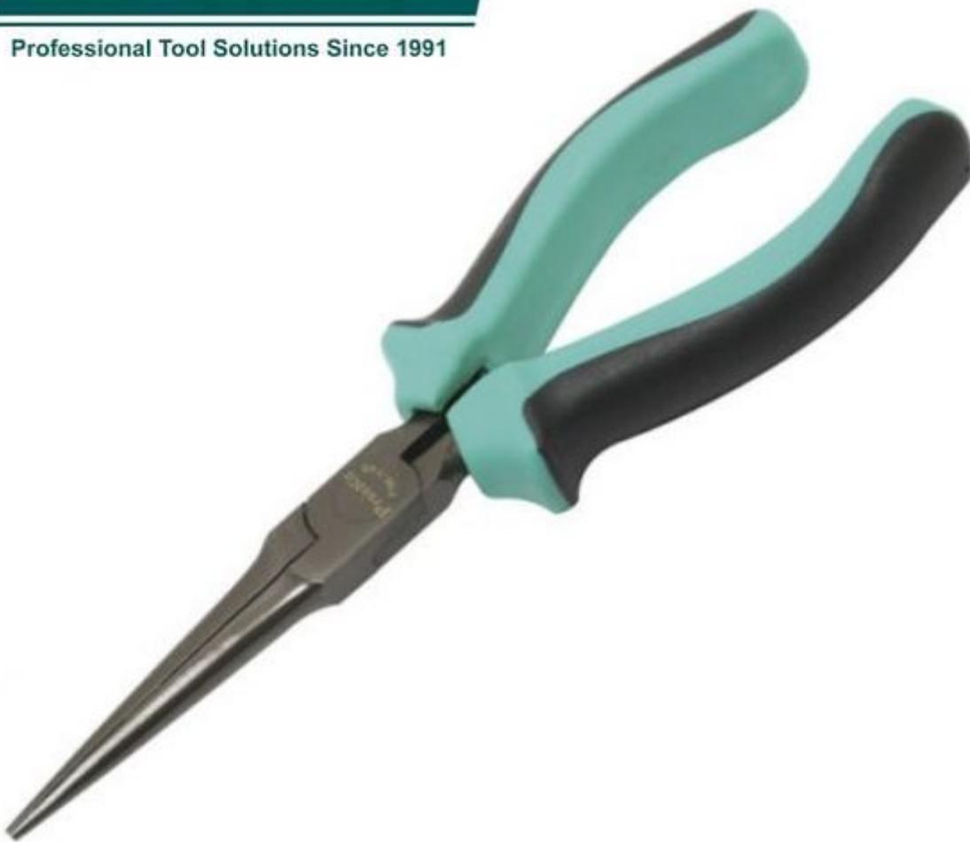
Pinza con becchi a punta lunghi 53mm. Particolarmente indicata per lavori di precisione e la presa di piccoli componenti. Costruzione in acciaio ad alto contenuto di carbonio per garantire la massima resistenza e nichelatura per evitare la corrosione . Molla di ritorno e impugnatura bicolore antiscivolo. Lunghezza totale 150 mm.
