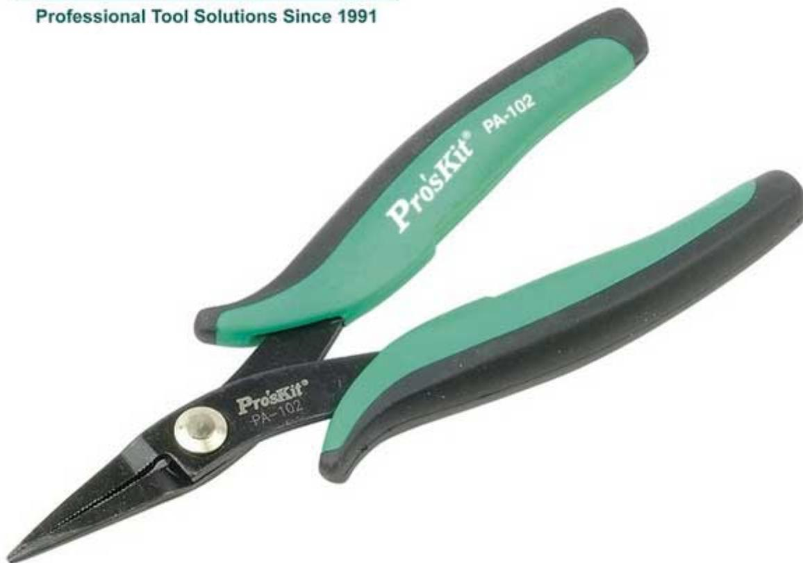
Pinza con becchi zigrinati lunghi a punta. Particolarmente indicata per la presa di componenti in punti poco accessibili e per lavori delicati in elettronica. Costruzione in acciaio ad alto contenuto di carbonio. Con molla di ritorno.
