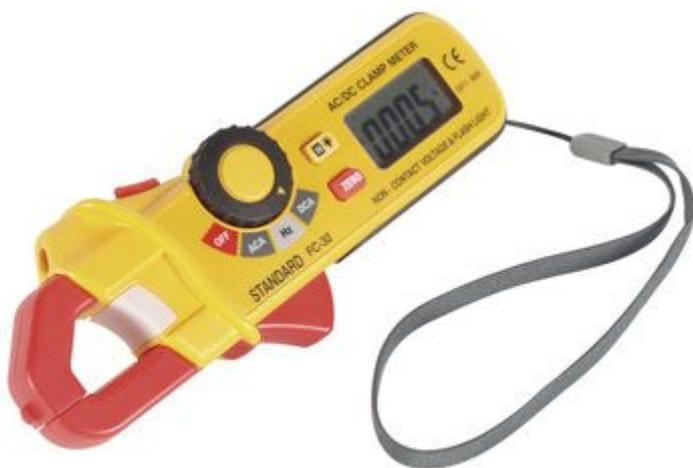
Pinza amperometrica con multimetro digitale con display LCD retro-illuminato da 3 2/3 cifre a 2400 conteggi. Memorizzazione dei dati, protezione contro i sovraccarichi, autospegnimento e indicatore di batteria scarica. Rileva tensioni alternate (indicatore luminoso) e misura correnti alternate continue e frequenza. Alimentazione con 2 batterie tipo AAA 1,5V. Viene fornito con custodia in plastica.
