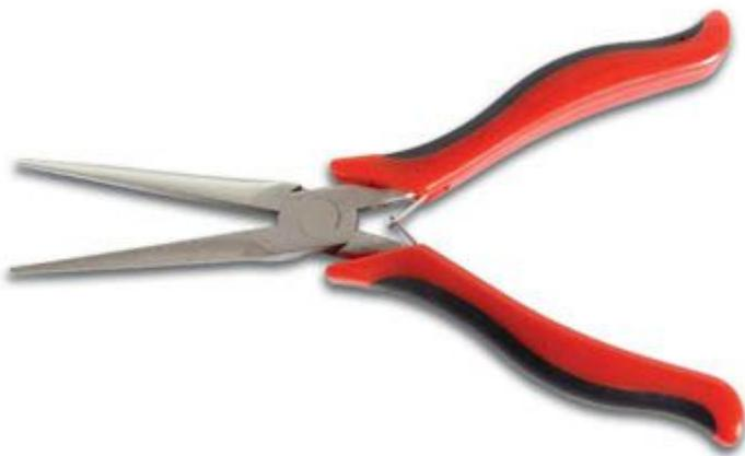
Pinza fine a becchi tondi e lunghi. Corpo in acciaio CR-V con finitura in nickel satinato. Impugnatura in ABS a doppia iniezione. Lunghezza: 150 mm.
