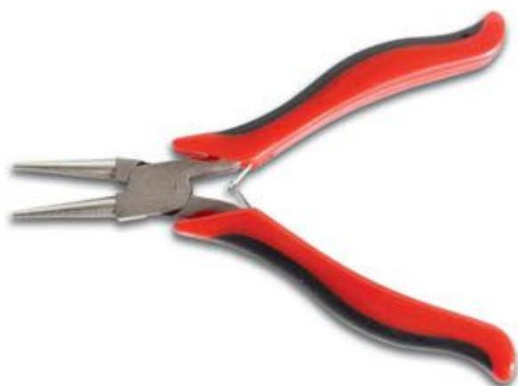
Pinza miniatura a becchi tondi. Corpo in acciaio CR-V con finitura in nickel satinato. Impugnatura in ABS a doppia iniezione. Lunghezza: 124 mm.
