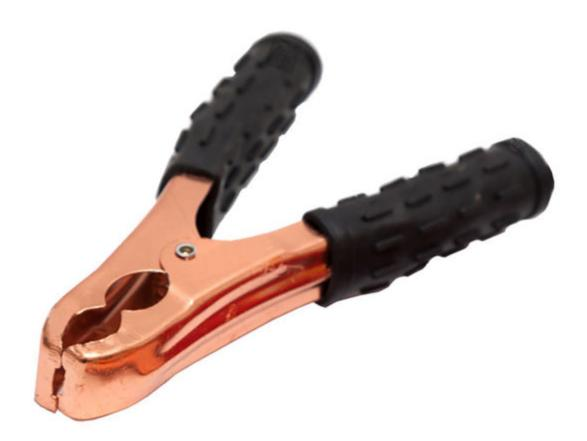
Pinza in metallo rivestita in rame per batteria. Corrente nominale 400 A, apertura max. 25 mm, terminazione: crimpatura o saldatura, materiale isolamento: PVC. Lunghezza pinza 140 mm.
