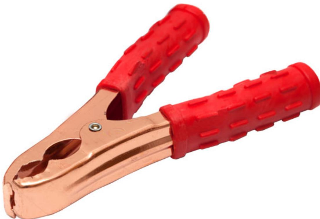
Pinza in metallo rivestita in rame per batteria. Corrente nominale 400 A, apertura max. 25 mm, terminazione: crimpatura o saldatura, materiale isolamento: PVC. Lunghezza pinza 140 mm.
