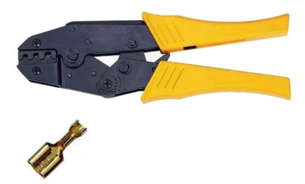
Pinza adatta a crimpare terminali faston non isolati. Adatta per cavi con sezioni da  $1,5 / 2,5 / 6 \text{ mm}^2$ . Dimensioni (mm): 225x72x21, peso: 526 grammi.
