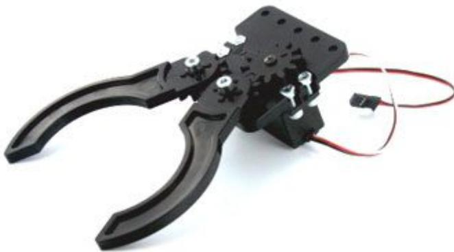
Pinza per robot in grado di afferrare vari oggetti. Dimensioni: lunghezza totale 15,5 cm, larghezza 6,1 cm (pinza chiusa). La confezione comprende: la pinza da assemblare, il servo per l'azionamento e i relativi accessori per il montaggio.
