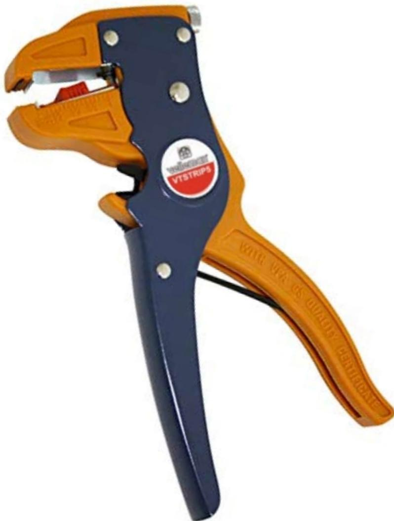
Pinza spelafili professionale a regolazione automatica con taglierina. Permette di spelare una porzione di filo elettrico, fino a 25 mm, avente una sezione compresa tra 0,2 e 6 mm<sup>2</sup>.
