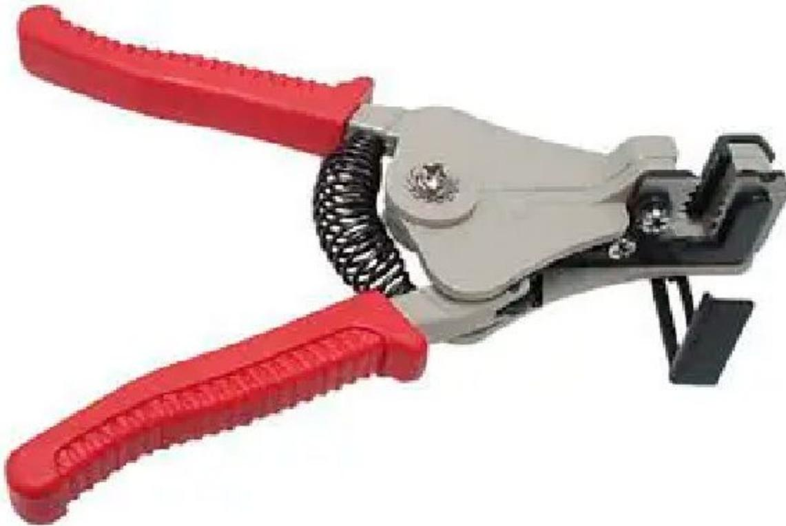
Pinza spelafili adatta alla spelatura di cavi con diametri differenti: 1/1.6/2/2.6/3 mm. Per utilizzarla è sufficiente inserire il filo nella sezione corrispondente e premere sull'impugnatura. Lunghezza della porzione spelabile regolabile mediante lamella di fine corsa.
