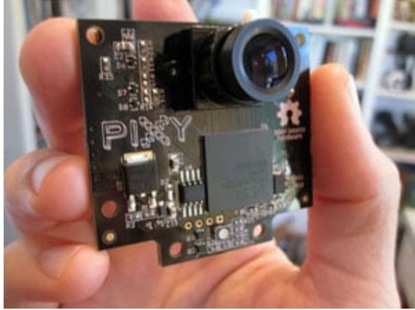
Pixy è una telecamera dotata di processore NXP LPC4330 dual core, sensore d'immagine Omnivision OV9715 da 1/4" con risoluzione 1280x800 pixel, due uscite per collegare due servo RC (che fungono da Pan/Tilt) e differenti interfacce per l'uscita dei dati (UART, SPI, I2C, uscita digitale o analogica).
