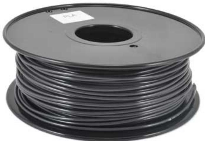
Questo particolare filamento di PLA, di colore grigio quando la temperatura è inferiore a 31°C, diventa bianco quando la temperatura è superiore a 31°C. Temperatura di stampa: 210°C-220°C. **N.B.** Il filamento non contiene sostanze nocive, rispetta la sicurezza sui giocattoli e le specifiche di confezionamento alimentare.
