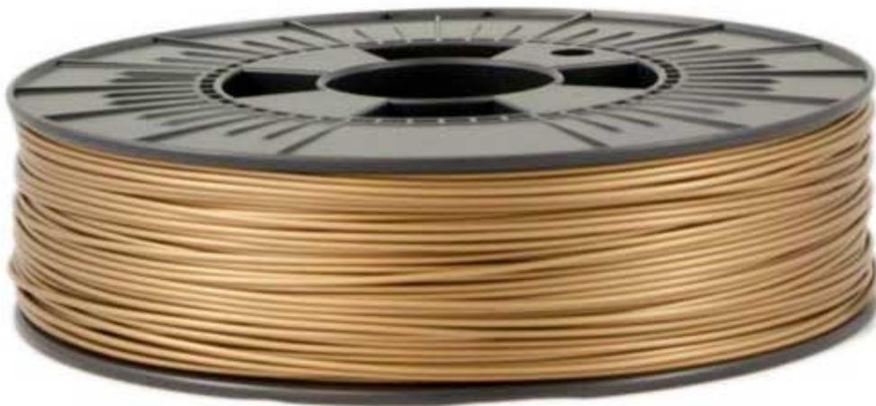
Bobina di PLA color bronzo per stampanti 3D. Facile da stampare a bassa temperatura, più duro e meno fragile del normale PLA, bassa deformazione e odore limitato. Diametro 1,75 mm, densità: 1,24 g/cm<sup>3</sup> (@ 21,5°C), temperatura di stampa: 180-210°C, resistenza all'urto: 7,5 kJ / m<sup>2</sup>, lunghezza: circa 114-120 metri, dimensioni bobina (mm): Ø 200x55, peso: 750 grammi.
