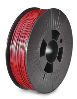
Bobina di PLA color rosso rame con glitter per ottenere un effetto metallizzato. Facile da stampare a bassa temperatura, più duro e meno fragile del normale PLA, bassa deformazione e odore limitato. Diametro 1,75 mm, densità: 1,24 g/cm³ (@ 21,5°C), temperatura di stampa: 180-210°C, resistenza all'urto: 7,5 kJ / m², lunghezza: circa 114-120 metri, dimensioni bobina (mm): Ø 200x55, peso: 750 grammi.
