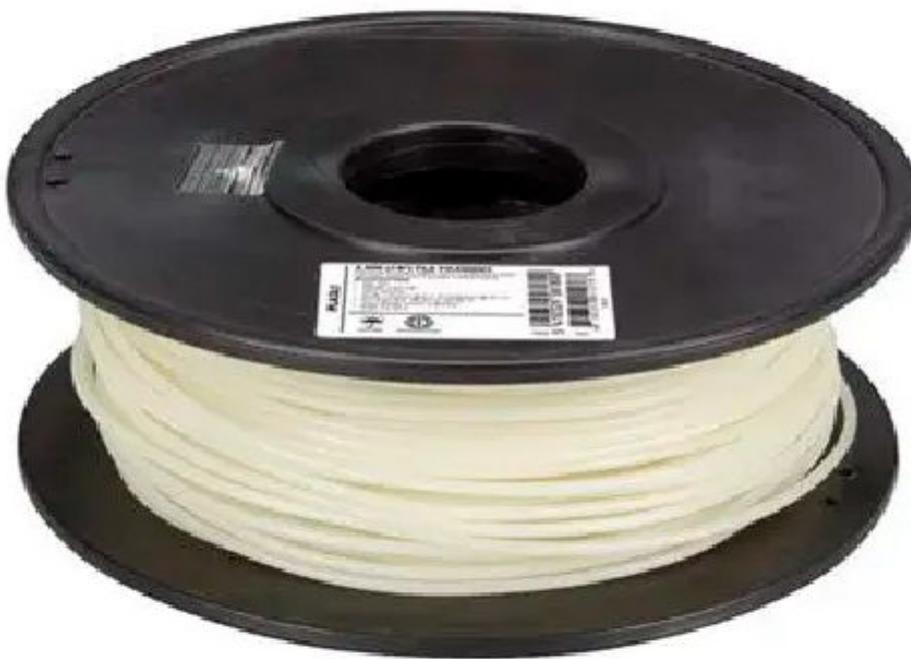
PLA luminescente per stampare oggetti che brillano al buio con luce verde fosforescente. Su bobina per stampanti 3D. Diametro 3 mm, densità: 1,25 g / cm<sup>3</sup> (@ 21,5°C), temperatura di stampa: 190-225°C, resistenza all'urto: 5 kJ / m<sup>2</sup>, lunghezza: circa 114-120 metri, dimensioni bobina: Ø 20 x 7 cm, peso: 1 kg.
