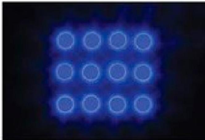
Modulo composto da 12 LED a luce blu ad alta luminosità. Alimentazione 12 Vdc, consumo: 1 W, flusso luminoso: 38 lumen, dimensioni: 17 x 20 mm.
