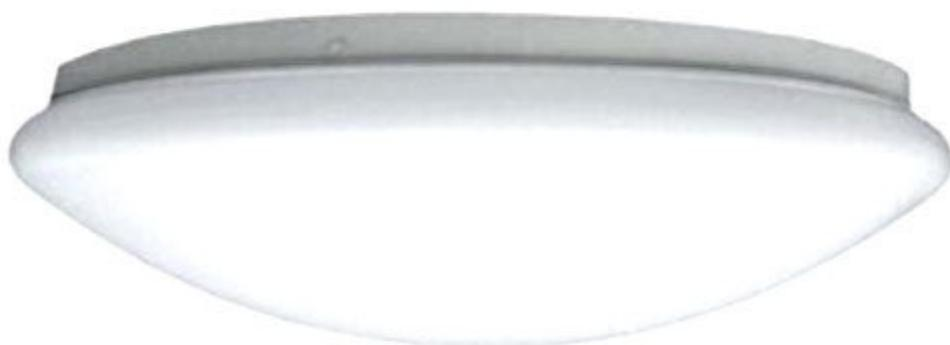
Dotata di LED bianco neutro da 32 watt, coperchio in acrilico bianco e base in metallo, permette di sostituire le plafoniere che utilizzano lampade tradizionali. Accensione istantanea, flusso luminoso: 1800 lumen, angolo di emissione 120°, alimentazione 220 Vac, consumo: 700 mA.
