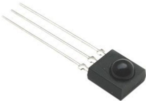
Sensore infrarossi con amplificatore, demodulatore e filtro tarato sulla frequenza di 38 KHz. Uscita compatibile con dispositivi TTL e CMOS, alimentazione compresa tra 4,7 e 5,3 volt, assorbimento 1,8 mA.
