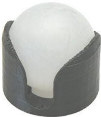
Il ball caster è impiegato come terzo punto d'appoggio nei robot. Composto da una piccola sfera in metallo che ruota all'interno di una struttura di plastica, può essere montato in modo da ottenere due altezze differenti, di 28 e 35,5 mm. Il kit contiene tutti i pezzi per realizzare un ball caster.
