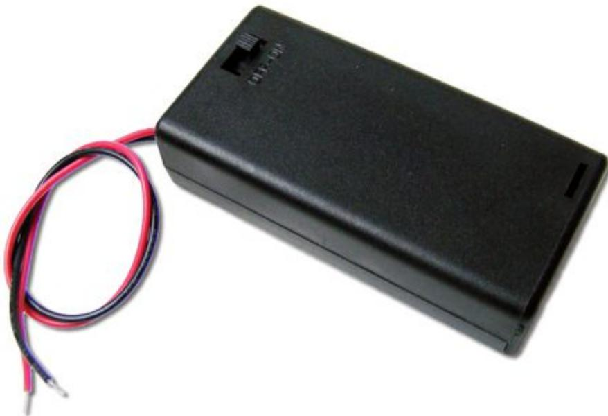
Portabatterie plastico con coperchio, interruttore e 2 fili per il collegamento. Adatto ad accogliere due batterie da 1,5 volt tipo AA. Dimensioni: 68,2x34,5x19,5 mm, peso: 20 grammi.
