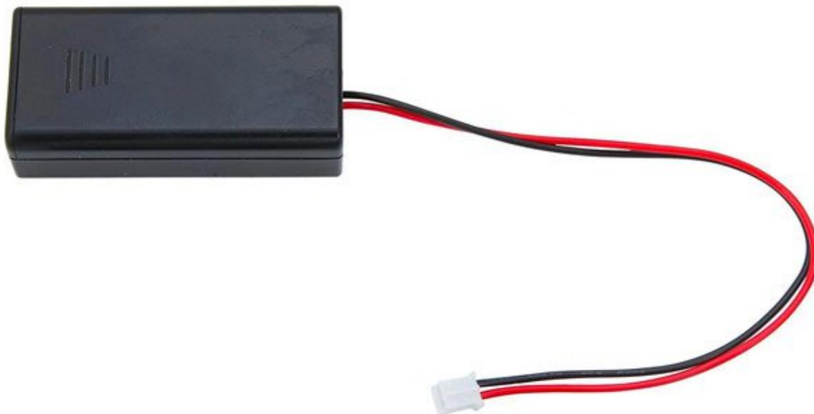
Portabatterie plastico con coperchio, interruttore, 2 fili con connettore per scheda Micro:bit. Adatto per accogliere due batterie da 1,5 volt tipo AAA. Dimensioni: 63x25,6x16,3 mm, peso: 25 grammi.
