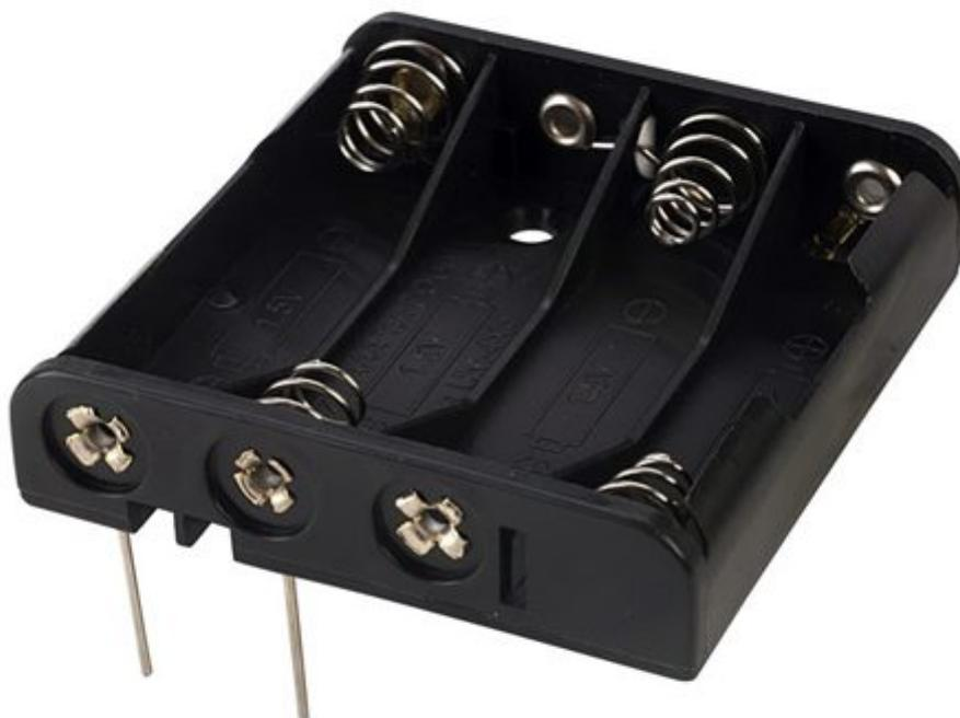
Portabatterie plastico adatto ad accogliere quattro batterie di tipo mini stilo (AAA). Terminali da circuito stampato, molle in acciaio nichelato, dimensioni: 54x50x13 mm.
