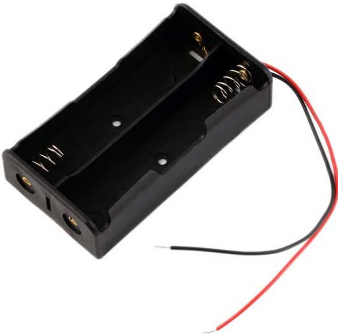
Portabatterie plastico con fili, adatto ad accogliere due batterie di tipo 18650 in connessione serie. L'uscita ai capi dei due fili sarà pari alla somma della tensione delle due batterie. Dimensioni (mm): 75x40x20, peso: 14 grammi.
