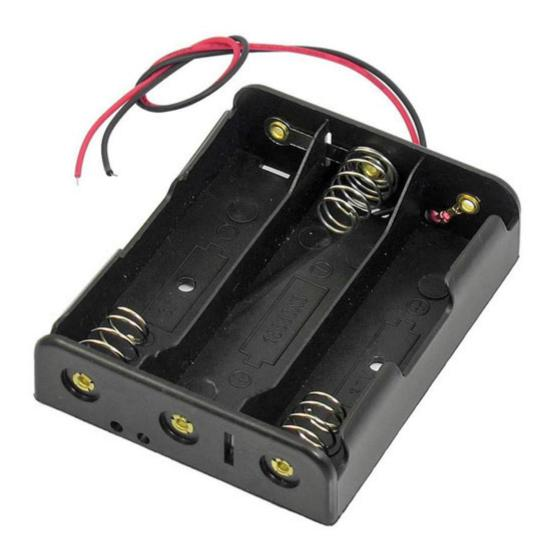
Portabatterie plastico con fili, adatto ad accogliere tre batterie di tipo 18650 in connessione serie. L'uscita ai capi dei due fili sarà pari alla somma della tensione delle tre batterie. Dimensioni (mm): 75x61x20, peso: 20 grammi.
