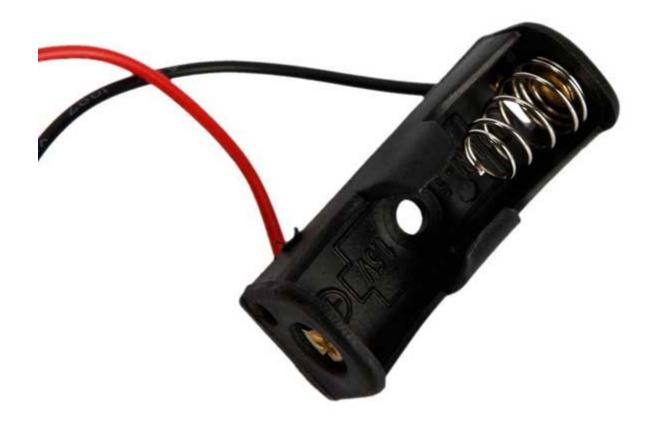
Portabatterie plastico con fili adatto ad accogliere 1 batteria da 12 V di tipo 23A (A23, 8LR23, ANSI-1181A, MN21, MS21, V23GA, VR22, 1811A, 3LR50, LR-V08, SES-23A, EL1 ). Dimensioni (mm): 35x13x12,45, lunghezza fili: circa 15 mm.
