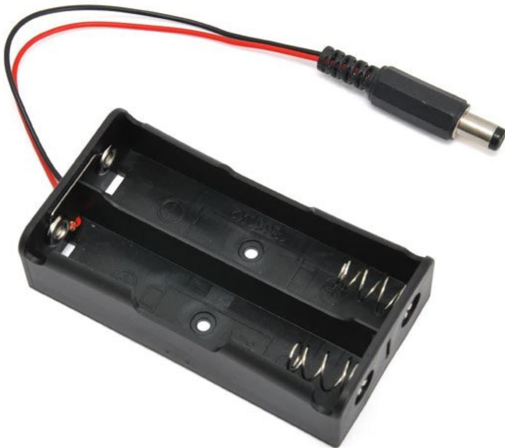
Portabatterie plastico con plug DC, adatto ad accogliere due batteria di tipo 18650 collegamento in serie (7,4 volt). Dimensioni (mm): 75x40x20, peso: 14 grammi.
