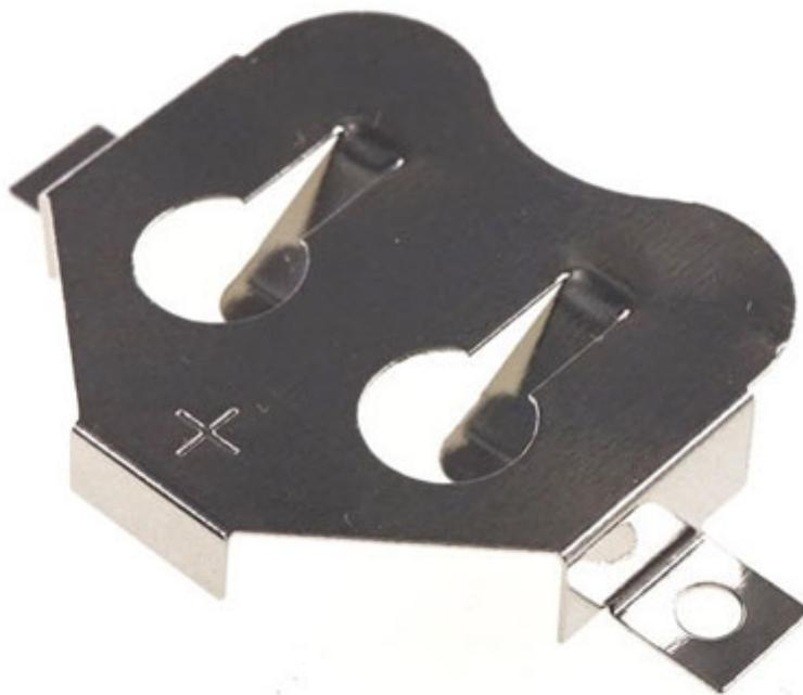
Portabatterie metallico per montaggio su PCB e con terminali a saldare SMD. Adatto ad accogliere una batteria di tipo CR2032. Dimensioni (mm): 30,5x19,9x3,3.
