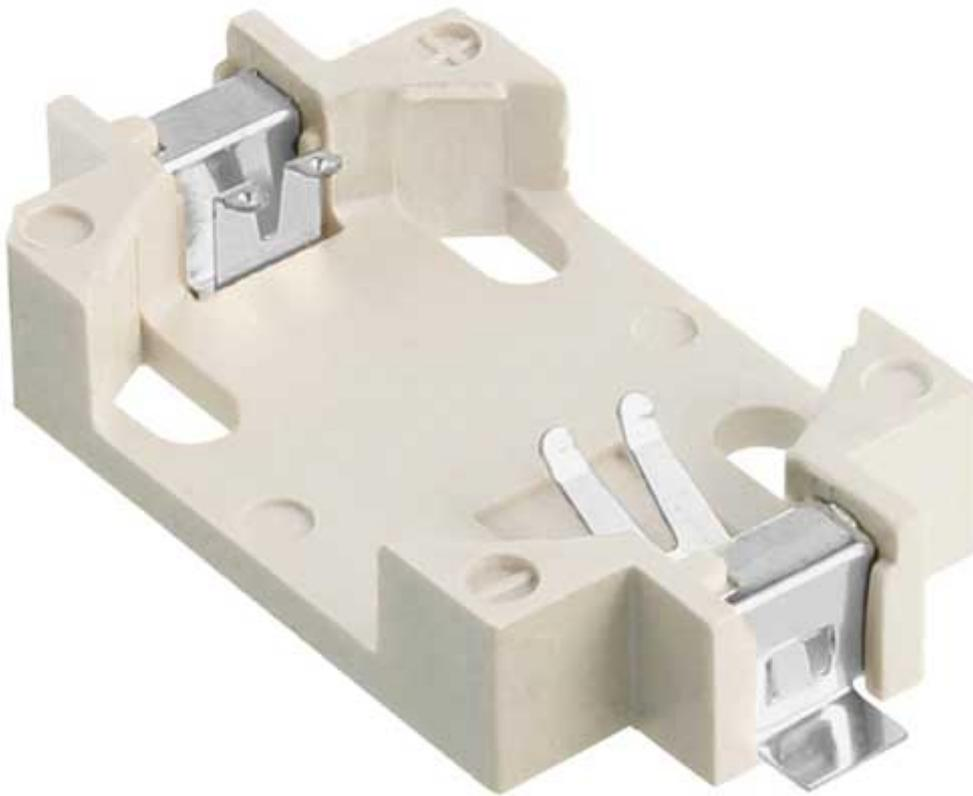
Portabatterie da PCB con terminali a saldare SMD. Adatto ad accogliere una batteria di tipo CR2032. Dimensioni (mm): 28,5x16x5,5.
