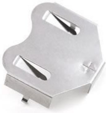
Portabatterie da c.s. adatto ad accogliere una batteria di tipo CR2450. La parte metallica è il positivo, il negativo deve essere realizzato sul PCB. Dimensioni: 25,47 mm x 22,68 mm.
