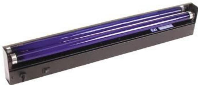
Portalampane in metallo verniciato nero completo di lampada UVB (luce di wood) da 20 W e sistema di accensione a 230 volt. Tubo UVB da 20W/60 cm, lunghezza d'onda della luce emessa: 365 nm, contenitore in metallo, alimentazione 230 VAC, interruttore di ON/OFF, dimensioni (mm) 670x110x60, peso 1,6 kg.
