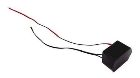
Potente inverter adatto a pilotare i cavi elettroluminescenti attraverso la scheda ELSHIELD. Alimentazione 5 Vdc, tensione di uscita: 110 Vac, lunghezza dei cavi: 30 cm cavo d'ingresso e 15 cm cavo di uscita, dimensioni (mm): 40 x 32 x 28.
