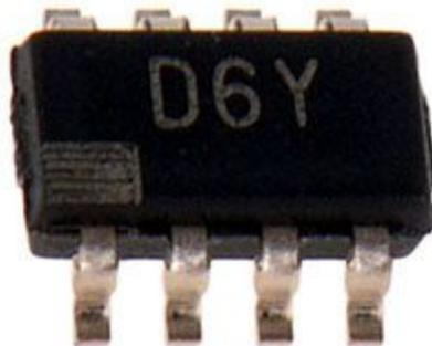
Chip con funzione di potenziometro digitale 10 kohm, 32 posizioni e semplice controllo manuale up/down. Alimentazione: da 2,7 volt a 5,5 volt, temperatura di lavoro: da -40°C a +105°C, case TSOT a 8 Pin, montaggio SMD.
