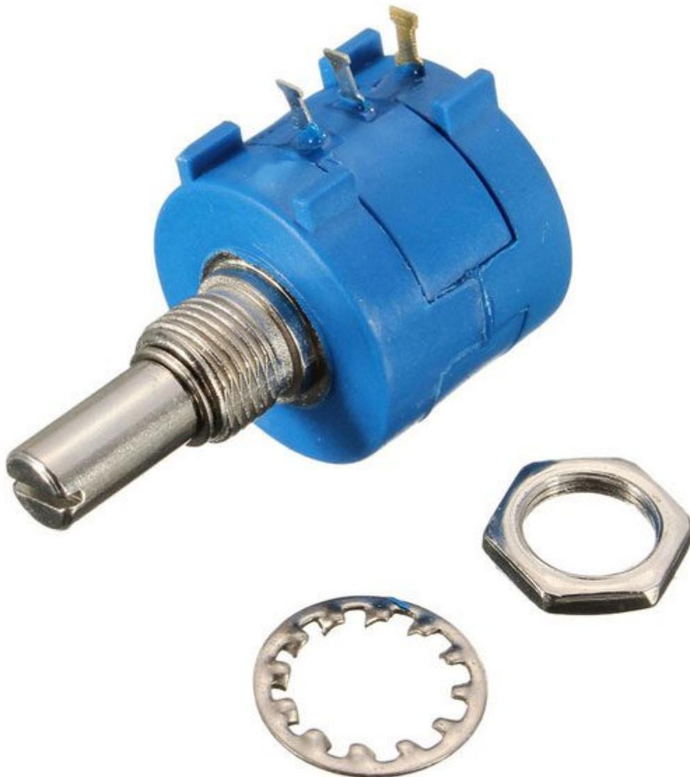
Potenzimetro rotativo di precisione (10 giri) 10 kohm, tolleranza: 5%, potenza nominale: 2 watt, diametro alberino: diametro 6,2 mm, lunghezza 12 mm, dimensioni max. corpo (mm): Ø22,6 x 18,7, peso: circa 19 grammi, temperatura di lavoro: da -40°C a +125°C, vita media: 1.000 ore, vita media giri dell'alberino: 1.000.000 di volte.
