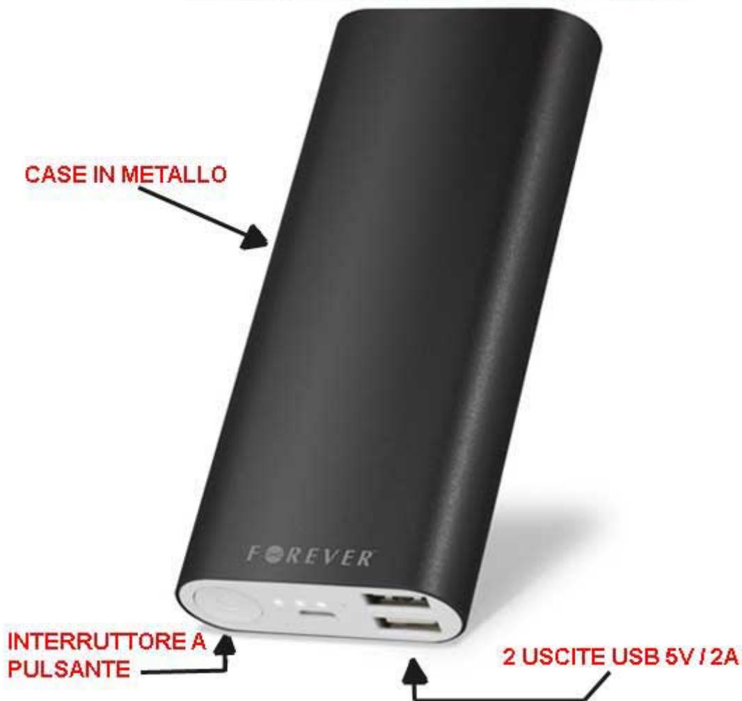
Power bank con batteria ad alta capacità (**13.000 mAh**) ai polimeri di litio e case in metallo. È in grado di ricaricare la batteria di smartphone, GPS, fotocamere e altri dispositivi alimentabili tramite USB. Dispone di due uscite USB da 5 V 2 A (ciascuna), indicatore dello stato di carica della batteria, ingresso micro USB per la ricarica della batteria del power bank, interruttore a pulsante per l'accensione. La confezione comprende il Power bank e un cavetto USB-micro USB.
