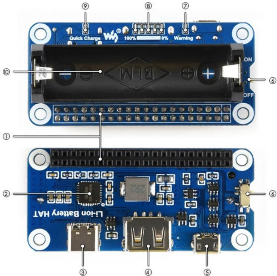
1. Connettore GPIO Raspberry Pi: per il collegamento a Raspberry Pi
