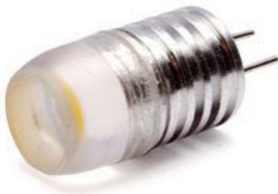
LED di potenza da 1 watt con attacco G4. Alimentazione: 12V AC/DC, flusso luminoso: 60-70 Lumen, colore: bianco caldo, dimensioni: 12 mm (diametro) x 28 mm (lunghezza).
