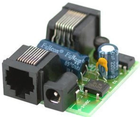
Piccola scheda [PoE](#) (Power over Ethernet) che permette di alimentare apparecchiature elettroniche, funzionanti con una tensione continua di 24 V, utilizzando lo stesso cavo che le collega alla rete dati [Ethernet](#).
