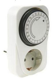
Permette di accendere e spegnere automaticamente, nell'arco delle 24 ore, qualsiasi elettrodomestico con potenza massima di 3500 Watt. Preciso e facilissimo da usare, per programmarlo è sufficiente spostare, verso l'alto, le levette posizionate sul disco rotante (ciascuna levetta corrisponde ad un intervallo di 15 minuti). Spina di tipo tedesco.
